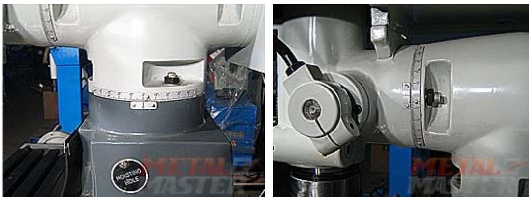
Поворот ручки обеспечивает быструю подачу пиноли, находящейся на фрезе и применяется при сверлении.
