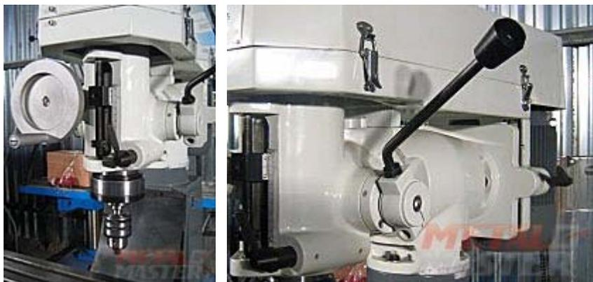
Быстрая подача пиноли осуществляется поворотом ручки, расположенной на фрезерной головке и используется для выполнения операций сверления.
