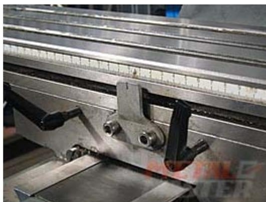
Маховики обеспечивают поперечное перемещение рабочего стола. Располагаются маховики по обеим сторонам стола. По длине стола находится шкала. Станок имеет фиксаторы для поперечного перемещения.
