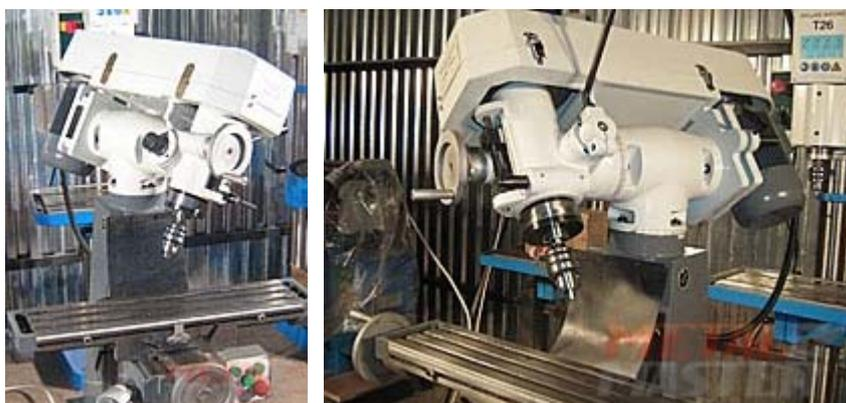
Фрезерная головка поворачивается на 360 градусов по вертикальной оси и наклоняется по продольной оси на 45 градусов в обе стороны. Угол наклона и поворота отображается на специальной линейке в месте соединения подвижных частей станка.
