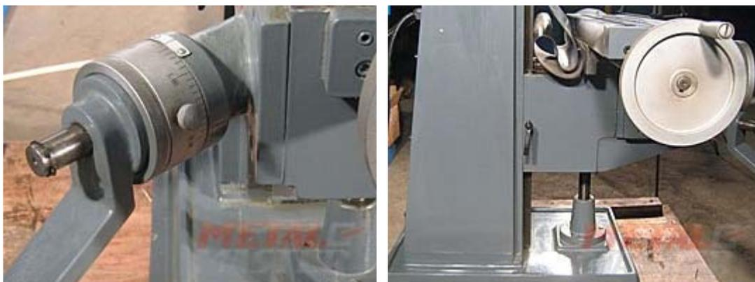
Стол поднимается вверх при помощи винтовой передачи. С боковой части станина располагается фиксатор для закрепления высоты подъема. Ручка оснащена шкалой и может быть выведена из сцепления с механизмом подъема для гарантии защиты от случайных изменений при позиционировании заготовки.
